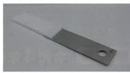
フッ素樹脂（PTFE）とマグネシウム（Mg）の接合加工サンプル▶
